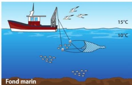
Le sonar calcule l'intervalle de temps séparant l'émission et la réception d'une salve ultrasonore. Dans la situation étudiée, l'intervalle de temps est 25 ms.
